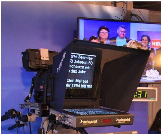
La pantalla está frente a la lente de una cámara o un teléfono inteligente moderno, y las palabras en la pantalla se reflejan en los ojos del presentador usando una hoja de vidrio transparente u otro divisor de haz, para que se lean mirando directamente a la posición de la lente, pero no son reflejados por la lente.
